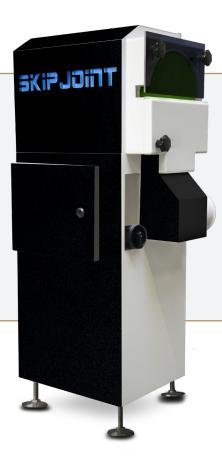
Geeignet zum einfachen, sicheren und schnellen Entfernen von Microjoints.
